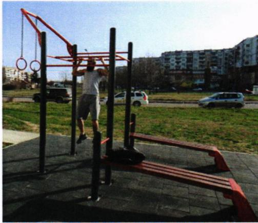
✓ 1 брой Многофункционален фитнес уред с два броя носещи колони изработени изцяло от метал, обработен с прахово полиестерно покритие. Съоръжението да е с размери минимум 3560 мм дължина и 2100 мм. ширина
