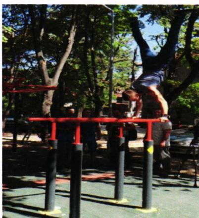
✓ 1 брой Мултифункционален стрийт фитнес уред с два броя носещи колони изработени изцяло от метал, обработен с прахово полиестерно покритие. Съоръжението е с размери минимум 1299 мм. дължина и 1233 мм. ширина.
