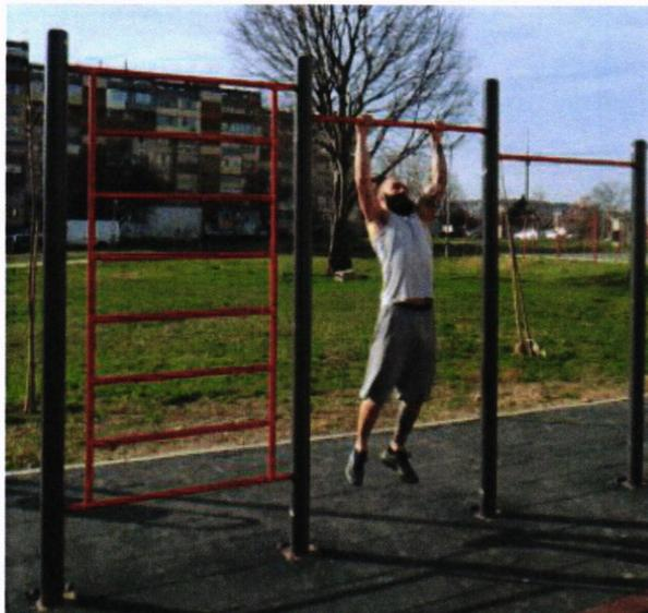
✓ 1 брой Мултифункционален стрийт фитнес уред с два броя носещи колони изработени изцяло от метал, обработен с прахово полиестерно покритие. Съоръжението да е с размери минимум дължина 1290 мм и ширина 1230 мм.
